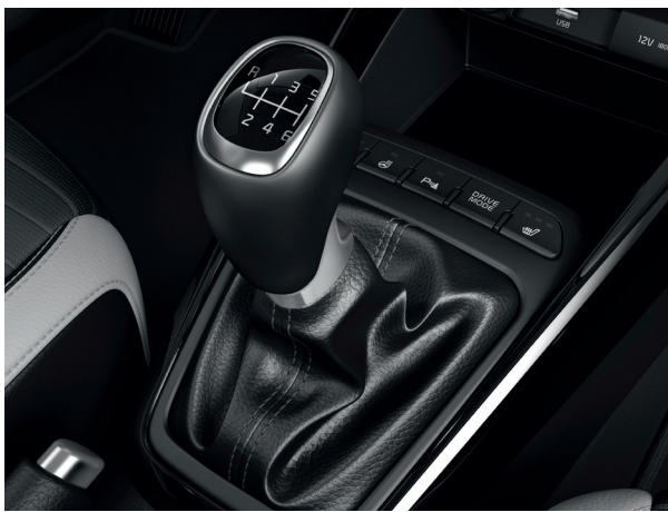
Boîte manuelle. Le Kia Stonic se dote d'une boîte manuelle à 6 rapports : disponible sur la motorisation 1.0 essence T-GDi 100 ch ISG BVM6 ou sur la motorisation 1.0 T-GDi 120 ch à hybridation légère (MHEV).
