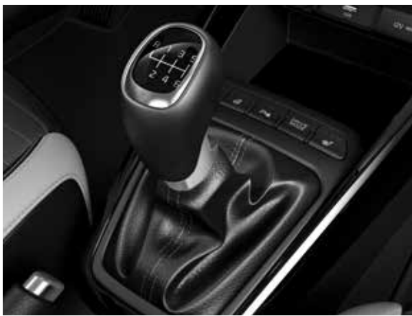
Boîte manuelle. Le Kia Stonic se dote de deux types de boîte manuelle à 6 rapports : une classique (BVM6) sur la motorisation 1.0 essence T-GDi 100 ch ISG BVM6, et une dotée d'un embrayage électronique (iBVM6) si elle couplée au système MHEV.
