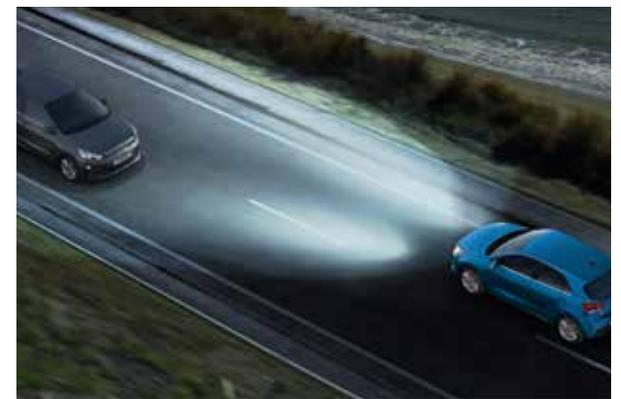
**Système de gestion intelligente des feux de route (HBA).** Lorsque les conditions le permettent, la Kia Rio passe automatiquement en feux de route. Lorsque la caméra sur le pare-brise détecte de nuit les projecteurs d'un véhicule circulant en sens inverse ou les feux arrière du véhicule qui vous précède, le système de gestion automatique des feux de route permute automatiquement en feux de croisement pour éviter tout éblouissement des autres conducteurs (en option ou de série selon finition).
