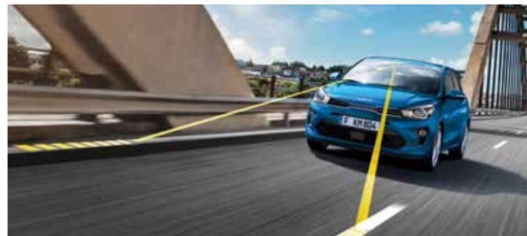
**Assistance active à la conduite (LFA) et aide au maintien dans la file (LKA).** Ce système utilise une caméra et des capteurs radar et surveille les marquages au sol pour maintenir le véhicule au milieu de sa voie de circulation. En cas de déport involontaire de la voie de circulation, le système émet un signal sonore, et sans action corrective de la part du conducteur, le véhicule revient dans sa voie de circulation grâce à l'action du volant (en option ou de série selon finition).
