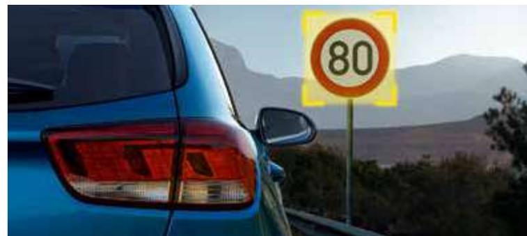
**Reconnaissance des panneaux de limitation de vitesse (ISLW).** Le système de reconnaissance des panneaux de limitation de vitesse vous fournit toutes les informations requises pour vous aider à respecter les limites de vitesse. Grâce à une caméra montée sur le pare-brise, il lit les panneaux de limitation de vitesse et de restriction de dépassement et affiche clairement les informations sur l'écran du système de navigation et sur le combiné des instruments (en option selon finition).
