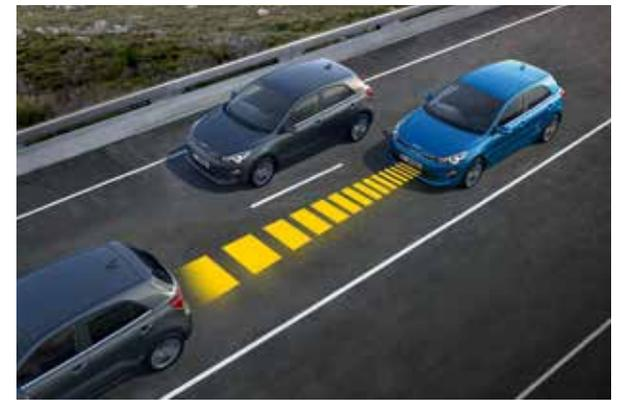
**Régulateur de vitesse adaptatif (SCC).** À l'aide d'un capteur radar et d'une caméra, le régulateur de vitesse adaptatif peut réguler la vitesse de la Kia Rio et sa distance par rapport au véhicule en amont. Le système maintient une distance de sécurité avec le véhicule qui précède en modulant automatiquement la vitesse de votre Kia Rio (en option sur GT-line Premium, uniquement disponible avec la boîte DCT).
