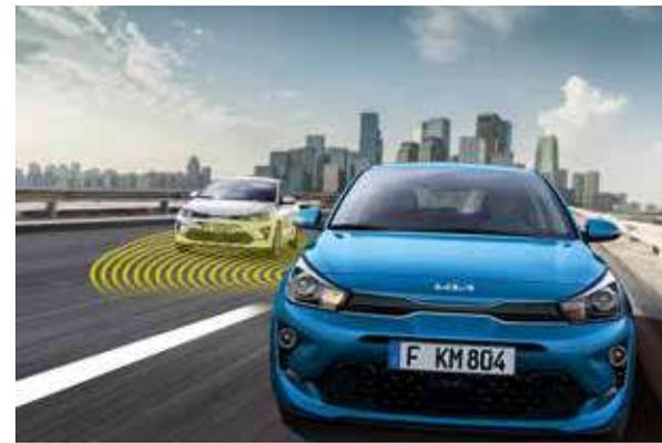
**Système de surveillance des angles morts (BCW avec boîte iBVM) & Système anti-collision avec détection des angles morts (BCA avec boîte DCT).** Le système de surveillance des angles morts est doté de radars qui surveillent les angles morts et vous alerte de la présence de véhicules dans cette zone par un symbole sur le rétroviseur extérieur du côté concerné. Combiné avec la boîte DCT, le système permet même d'intervenir sur les freins si nécessaire (en option sur GT-line Premium).
