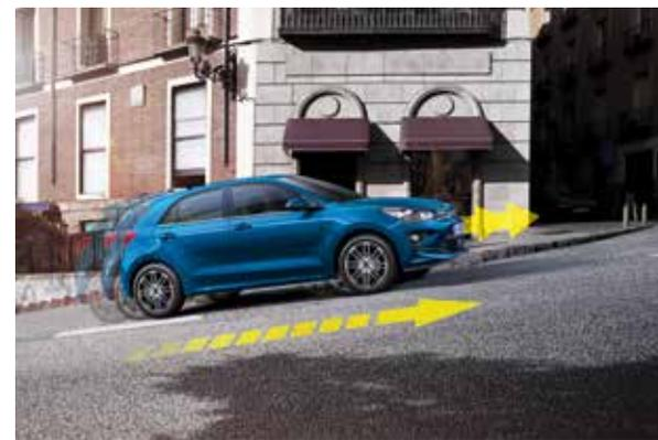
**Aide au démarrage en côte (HAC).** À l'arrêt dans une pente, le système HAC vous permet de démarrer sans stress en bloquant automatiquement les freins pendant 2 secondes, vous laissant le temps de positionner votre pied sur l'accélérateur (de série).
