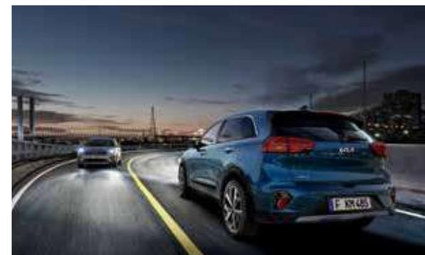
**Système de gestion intelligente des feux de route (HBA).** Des caméras intégrées au pare-brise détectent les véhicules arrivant en sens inverse la nuit et passent automatiquement en feux de croisement pour éviter d'aveugler les autres conducteurs. Une fois que le véhicule en sens inverse est passé, les feux de route se rallument (de série).
