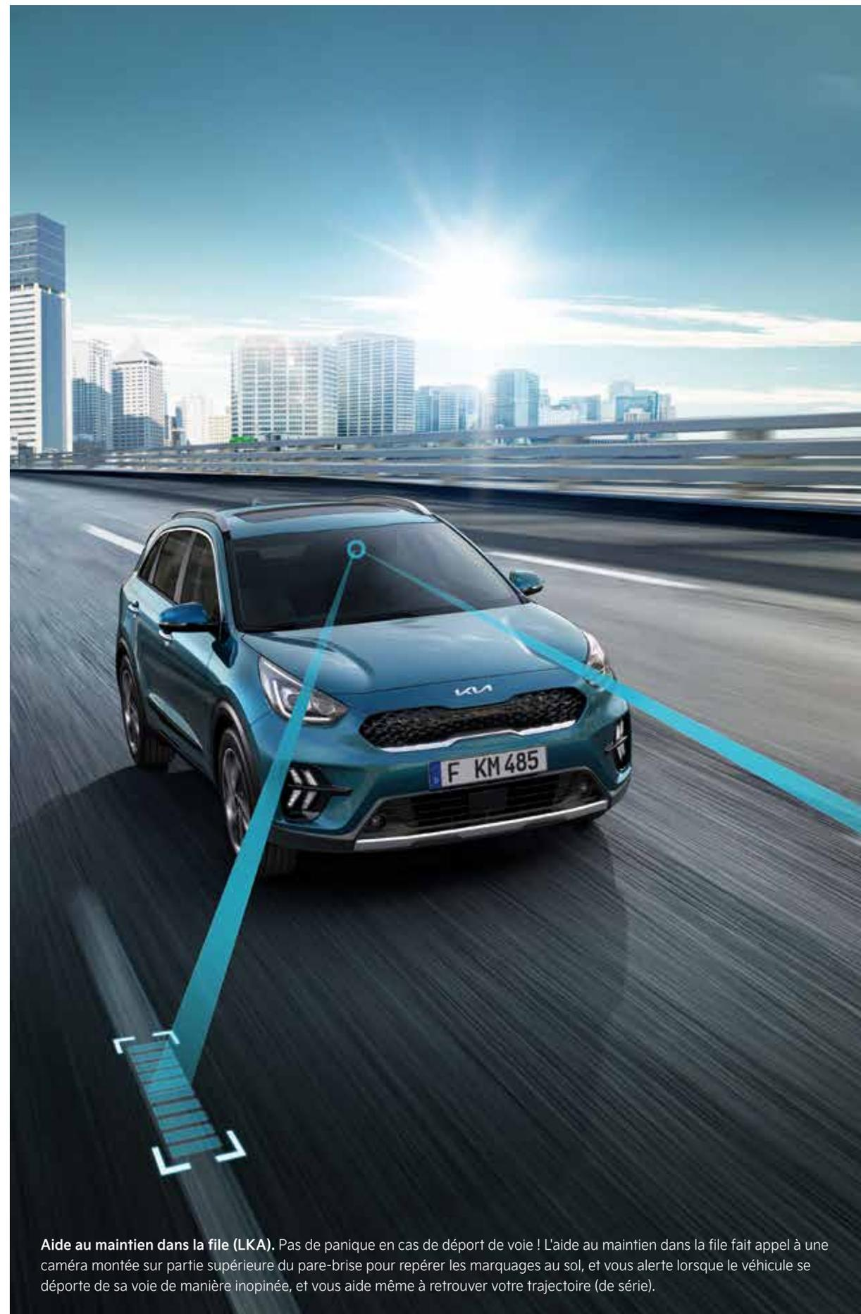
**Aide au maintien dans la file (LKA).** Pas de panique en cas de déport de voie ! L'aide au maintien dans la file fait appel à une caméra montée sur partie supérieure du pare-brise pour repérer les marquages au sol, et vous alerte lorsque le véhicule se déporte de sa voie de manière inopinée, et vous aide même à retrouver votre trajectoire (de série).
