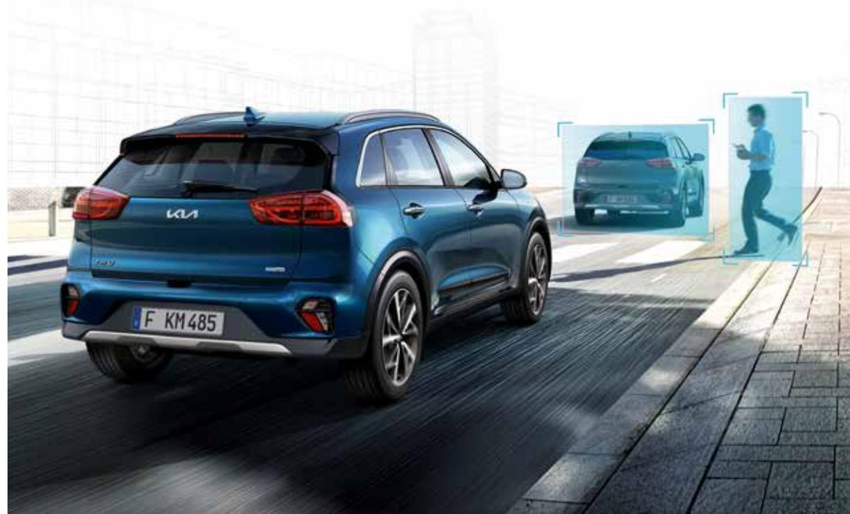
**Système de freinage d'urgence autonome (FCA)<sup>(1)</sup>.** A l'aide de capteurs et d'une caméra, ce système est capable de détecter un risque de collision avec un piéton ou avec le véhicule qui vous précède. Sans réaction du conducteur après émission de l'alerte sonore, le système freine automatiquement afin d'éviter l'accident ou d'en minimiser l'impact (de série dès la finition Active pour la version hybride, dès Motion pour la version hybride rechargeable et le e-Niro).
