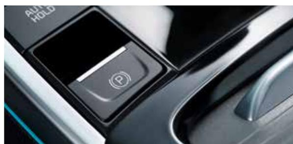
**Frein de stationnement électrique.** Finis les leviers encombrants. Il vous suffit d'appuyer sur un bouton pour activer le frein de stationnement.
