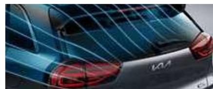
**Becquet arrière.** Le becquet arrière est secondé par des déflecteurs latéraux parfaitement intégrés et enveloppant les feux arrière. L'ensemble favorise l'écoulement de l'air.
