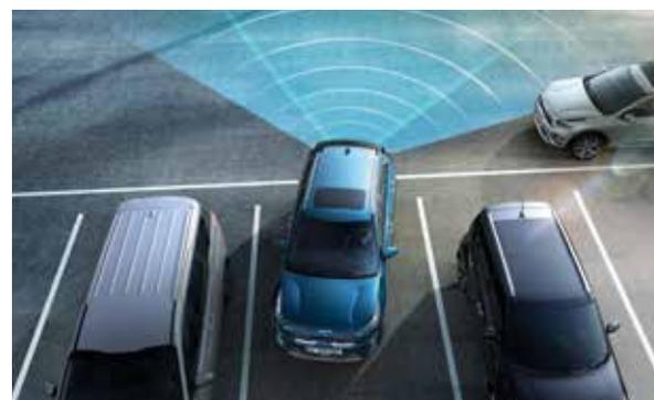
**Système de détection de trafic arrière (RCCW).** Lorsque vous quittez une place de stationnement en marche arrière, le système de détection de trafic arrière vous alerte si un véhicule est en approche latérale (en option sur les versions hybride, hybride rechargeable et de série sur la finition Premium de e-Niro).
