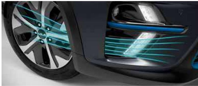
**Prise d'air latérale.** Cette prise d'air crée un flux accéléré à l'avant, réduisant la traînée causée par les turbulences de l'air afin d'améliorer l'aérodynamisme.
