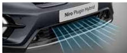
**Volets de calandre actifs.** Ces volets s'ouvrent et se ferment en fonction de la vitesse, permettant d'optimiser le refroidissement moteur et la résistance aérodynamique.
