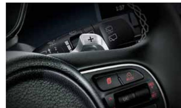
**Double fonctions des palettes au volant.** Les palettes au volant des versions hybride et hybride rechargeable proposent une double fonctionnalité : en mode ECO, elles servent à moduler la puissance de freinage régénératif. En passant au mode SPORT, les palettes permettent au conducteur de changer les rapports de vitesse, procurant une conduite plus dynamique (de série dès la finition Active).
