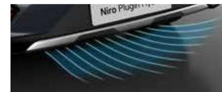
**Diffuseur arrière.** Cet élément ainsi que le silencieux d'échappement au design profilé permettent de réduire la traînée aérodynamique.
