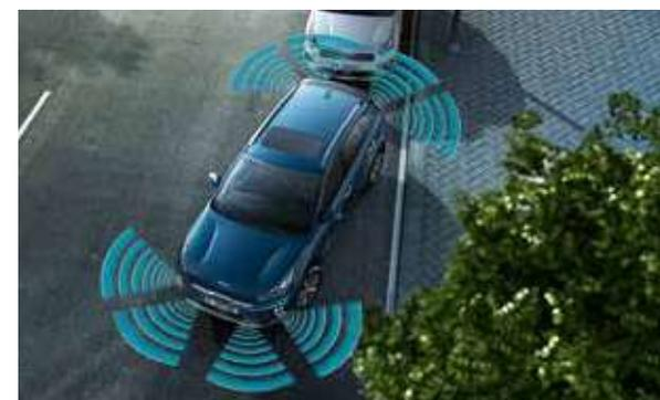
**Radars de parking avant et arrière.** Les radars de parking avant et arrière font appel à des capteurs montés à l'avant et à l'arrière du véhicule pour vous avertir des obstacles lors de vos manœuvres de stationnement (de série dès la finition Active).
