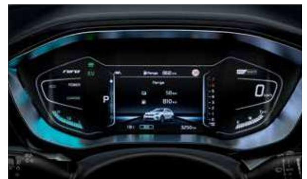
**Ecran TFT LCD 7" Supervision.** Idéalement placé au centre du combiné d'instruments, l'écran Supervision couleur est une mine d'information. Température extérieure, alerte de chute de pression des pneumatiques, rappel du système de navigation, mais aussi fonctionnement du système hybride et données sur votre consommation sont parmi les nombreuses fonctions à découvrir (de série sur la finition Lounge des versions hybride et hybride rechargeable).
